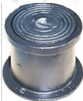
VF ΦΡΕΑΤΙΟ ΒΑΝΑΣ B125 ΔΙΑΣΤΑΣΕΙΣ:Υ180mm - Φ120mm 8,0Kg
